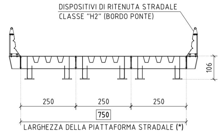
SEZIONE TRASVERSALE DELL'IMPALCATO STRADALE IN CORRISPONDENZA DEGLI APPOGGI SU UNA SPALLA
